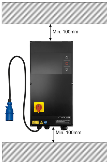
Abbildung 1: Montage der Steuerung
